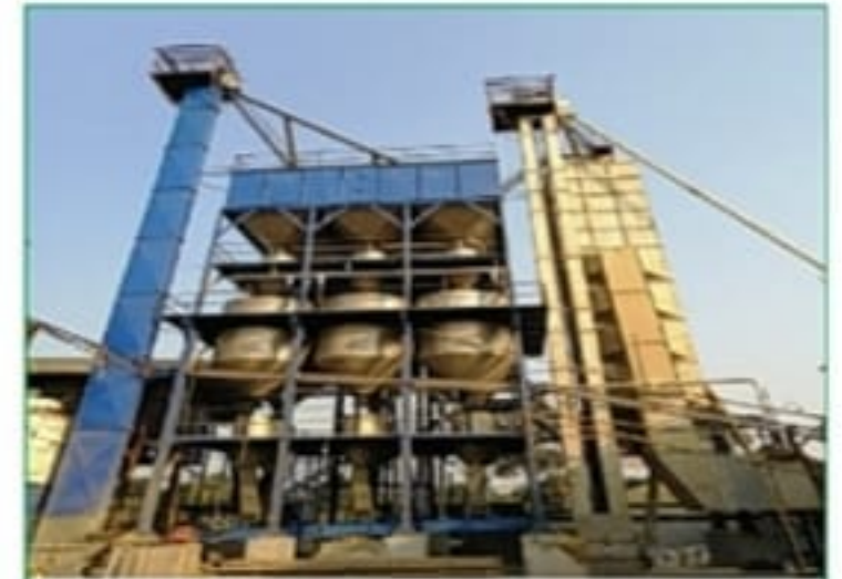
মোর্গান রবিউল হকলার এন্ড চাউল কল, মোকামতলা, বগড়া। প্রতিদিন ৯৬ টন ক্ষমতাসম্পন্ন পারবেয়েলিং এবং ড্রায়ার, ৫ টন মিলিং ও ৪ টন বয়লার।
